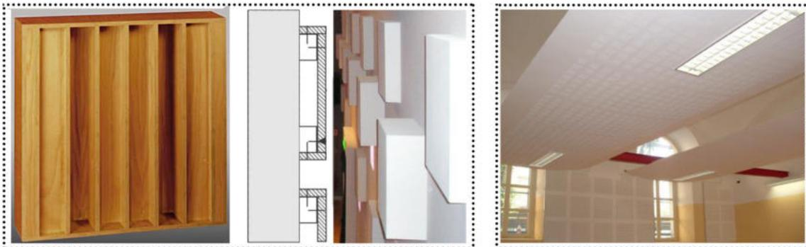
Figura 5.2 Trattamenti diffondenti: a sinistra un pannello fonodiffondente commerciale; al centro una struttura a scatola in lastre di gesso che diffonde il suono, vista in sezione e una volta collocata a parete; a destra un trattamento fonoassorbente tramite pannelli sospesi che eliminano il rischio di concentrazioni sonore dal soffitto voltato
