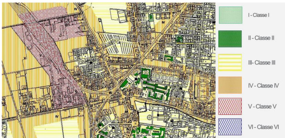
Figura 1.1 Esempio di parte di un piano di classificazione acustica del territorio
