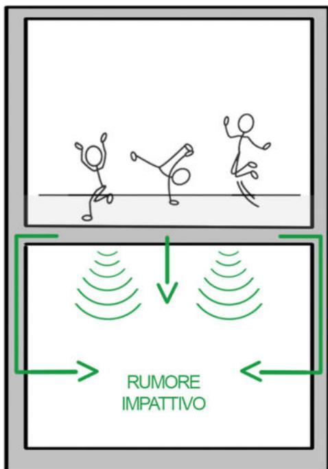
Figura 3.2 Esempio di trasmissione del rumore impattivo
