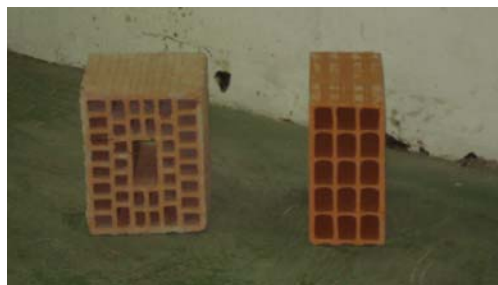
Figura 3 – I blocchi di laterizio usati per realizzare la parete laterale (a sinistra) e la parete in prova (a destra)
