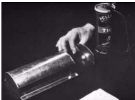
Fig. 7 – Modello ottico di una sala con soffitto concavo per lo studio della distribuzione dell'energia sonora sul pavimento della platea
