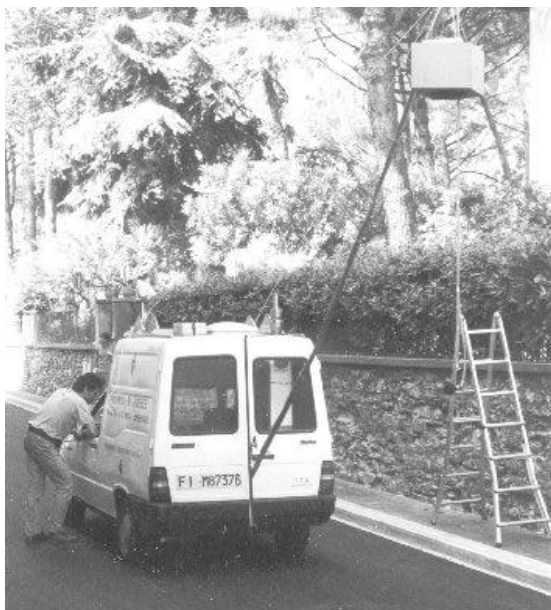
Figura15: La strumentazione impiegata per le misure in situ del coefficiente di assorbimento acustico.
