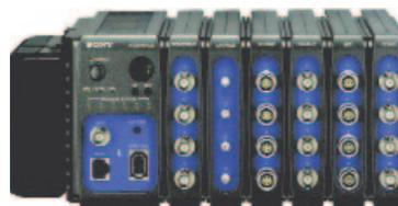
Al sistema sono poi collegati trasduttori per il rilevamento del numero di giri e per altre grandezze di controllo. La parte software dBFA e *Vib-Graph* provvede alla gestione dell'acquisizione e all'analisi, al controllo dei limiti di riferimento di vibrazione e di rumore. Ogni utensile viene periodicamente controllato, e solo se supera tutti i test viene rimesso a disposizione degli operatori, altrimenti viene inviato al servizio di manutenzione.
