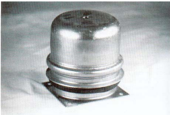
Fig. 39 Antivibrante pneumatico ("molla pneumatica"). Si noti il soffietto in materiale resiliente posto fra la base e la parte superiore metallica. Si tratta di un antivibrante "a lobo", il tipo più efficace.
