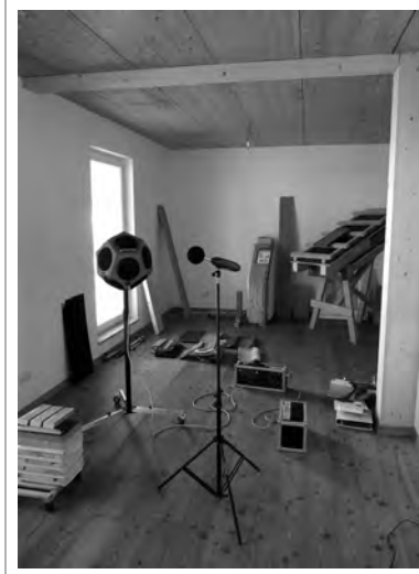
Figura 4.18 L'attrezzatura di misurazione acustica: cassa dodecaedrica e fonometro classe 1
