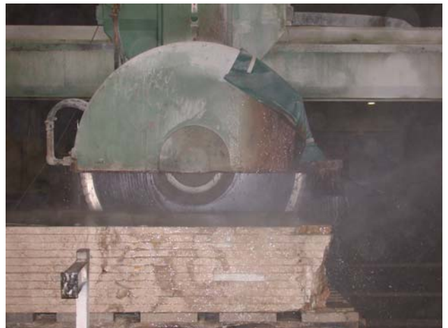
Figura 2 – Fresatrice a ponte con disco diamantato “tipo A” impiegata per la sperimentazione
