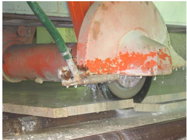
Figura 1 – Fresatrice attestatrice con disco diamantato “tipo SW” impiegata per la sperimentazione
