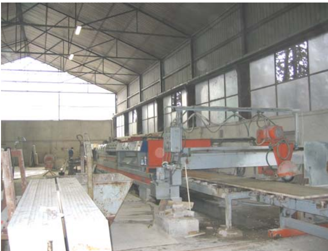
Figura 1 – Fresatrice attestatrice con disco diamantato “tipo SW” impiegata per la sperimentazione
