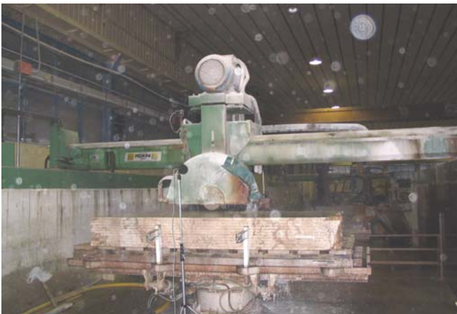
Figura 2 – Fresatrice a ponte con disco diamantato “tipo A” impiegata per la sperimentazione
