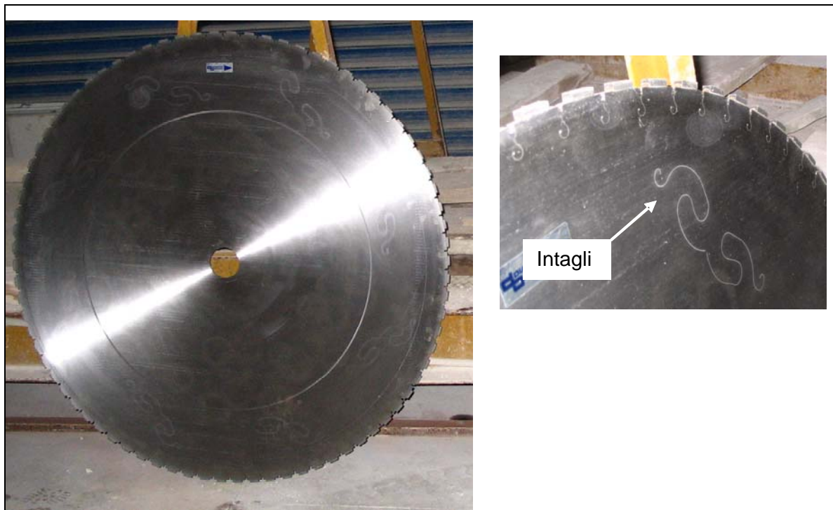
Fig. 4 – Lama silenziata mediante intagli (tipo A)
