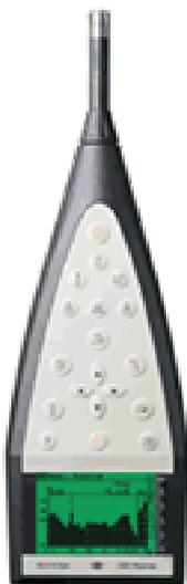
Il calcolo del  $L_{Aeq}$  avviene direttamente dallo strumento di misura attraverso un *circuito mediatore*. Lo strumento dotato di tale opzione prende il nome di **fonometro integratore**.
