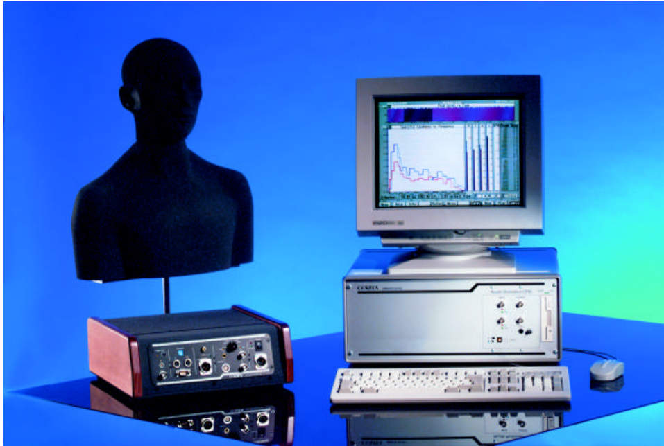
figura 3 : Sistema per Sound Quality composto da testa artificiale e da workstation di elaborazione, filtraggio digitale e simulazione. Nel sistema rappresentato la memorizzazione del segnale audio avviene direttamente nel hard disc contenuto all'interno della workstation. (Neutrik Cortex)
