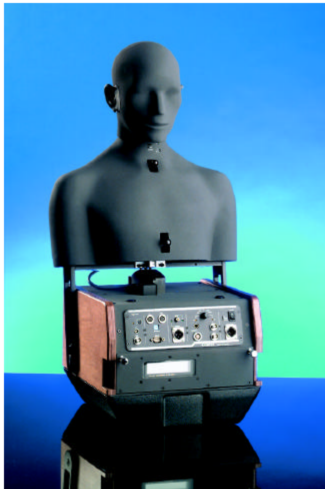
figura 1 : Simulatore di testa e torso per registrazioni. Nella parte inferiore dell'apparecchio è alloggiata l'elettronica di condizionamento del segnale ed un registratore digitale di tipo DAT. (Neutrik Cortex)
