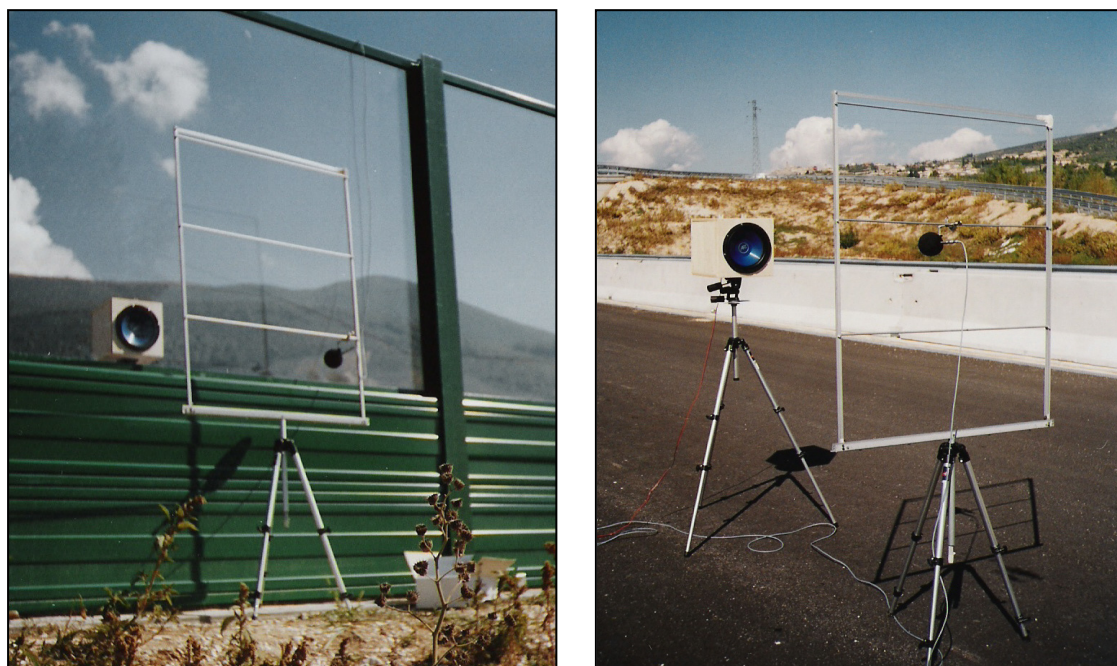
Figura 5 – Catena di misura per la prova di fonoisolamento
