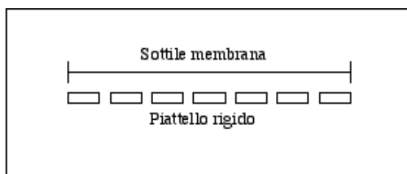
Fig. 6 - Schema del microfono a condensatore
