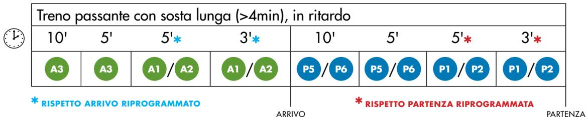
Gli annunci di preavviso P5/P6 e P8, che sono funzione del tempo di sosta del treno, non possono essere erogati prima dell'ultimo annuncio di arrivo e decadono al momento della diffusione del primo annuncio di partenza.
