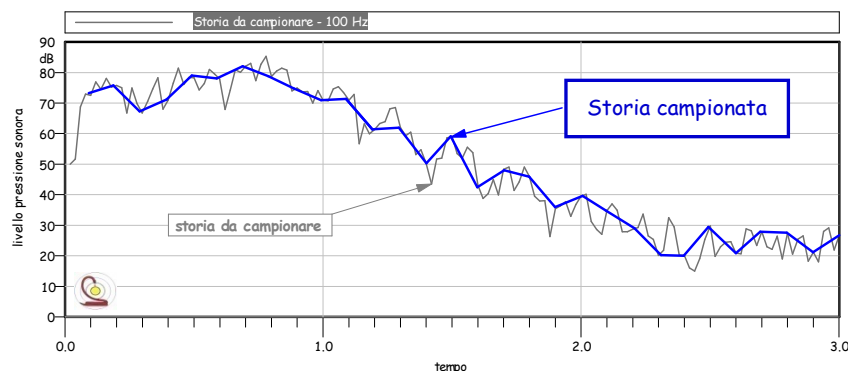
Figura 21: esempio di distorsione di una storia da campionamento insufficiente.-
