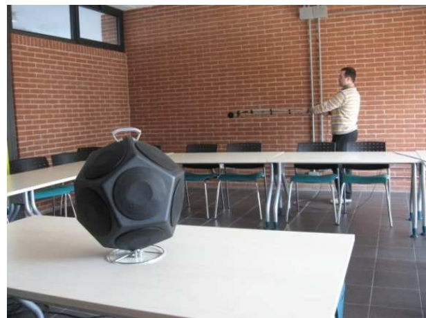
Figura 1: macchina da calpestio elettromagnetica SEM50, omologata dal PTB, e la sorgente isotropica DL304 con magneti al neodimio (leggera:9,5 kg). -
