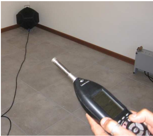
Figura 30: posizione microfono - sorgente e quattro misure fatte nella stessa posizione. -
