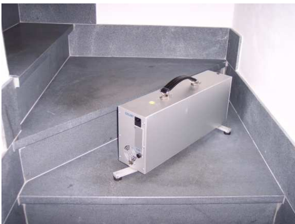
Figura 1: macchina da calpestio elettromagnetica SEM50, omologata dal PTB, e la sorgente isotropica DL304 con magneti al neodimio (leggera:9,5 kg). -
