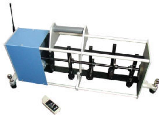
Le moderne macchine da calpestio sono dotate di batterie ricaricabili per evitare la necessità di corrente elettrica nel cantiere, e di telecomando per poter essere azionate da una sola persona presente al piano di sotto dove viene posizionate l'apparecchiatura di misurazione.
