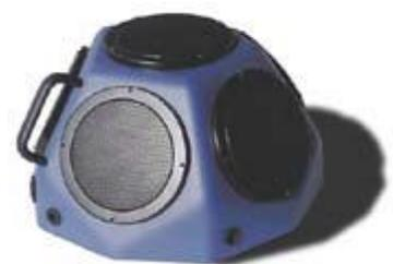
Il livello di emissione della sorgente è un altro fattore importantissimo da tenere in considerazione. Poiché, per la misura del tempo di riverberazione in particolare e per la misura di isolamento acustico in generale, è necessario registrare il decadimento dell'energia sonora o una differenza di livello di almeno 30dB (T30) per ogni banda di frequenza, la sorgente dovrà essere in grado di
