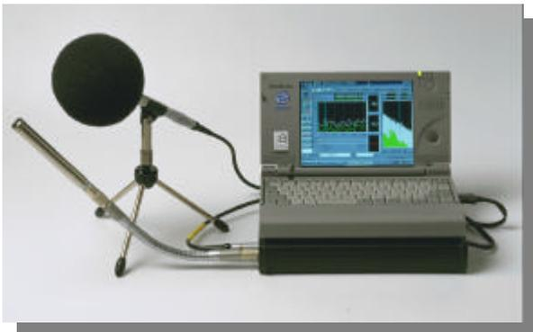
misura del tempo di riverberazione viene avvantaggiata dall'uso di un analizzatore di frequenza bicanale, perché possono essere rilevati contemporaneamente i decadimenti dell'energia sonora in più punti della sala e
