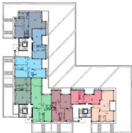
figura 2 – Caso di studio ANCE-ITC: suddivisione in tipologie di unità abitative per la verifica dell'isolamento acustico
