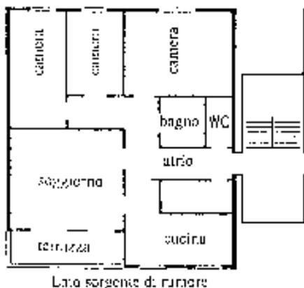
**Fig. 10.7** - Le camere da letto sono situate sul lato opposto a quello del rumore; il vano scale ha una doppia intercapedine; i servizi sono posti verso il vano scale. La posizione un po' meno idonea del soggiorno viene migliorata con la presenza di una terrazza protetta da un parapetto massiccio (Direttiva ÖAL n. 26)
