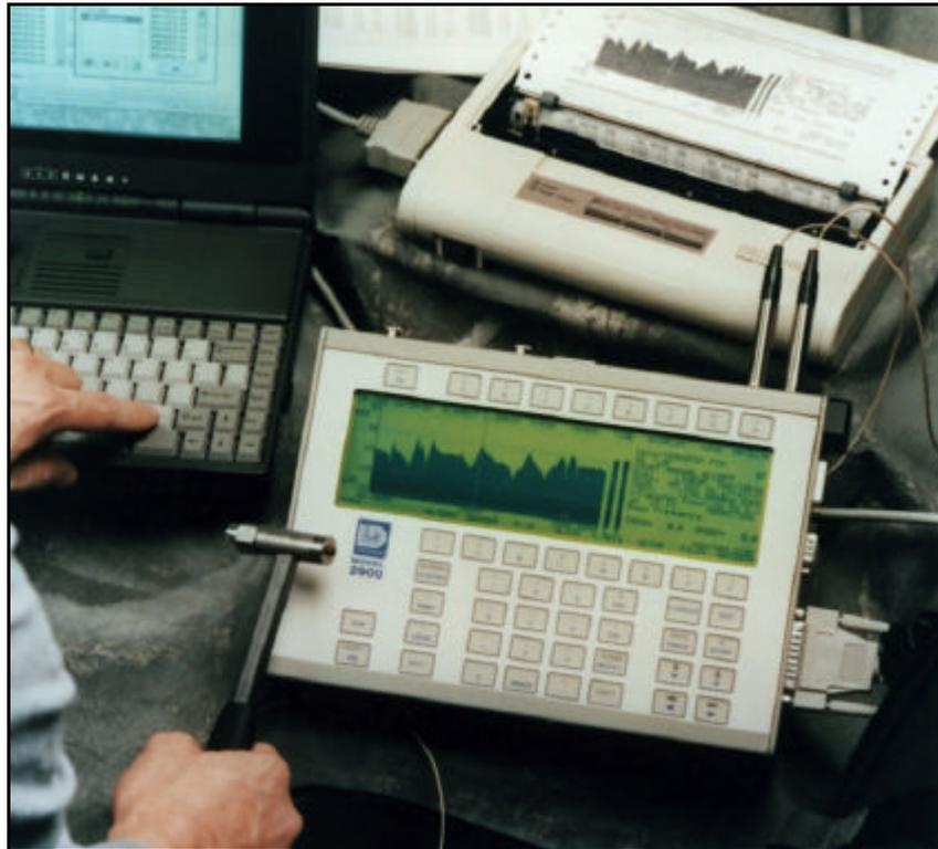
*Figura 2: Analizzatore di spettro portatile a due canali, per analisi acustiche e di vibrazione, collegato a martello strumentato con trasduttore di forza e ad accelerometro. La funzione raffigurata sul display è la Frequency Resonse Function. (Larson & Davis Inc.).*
